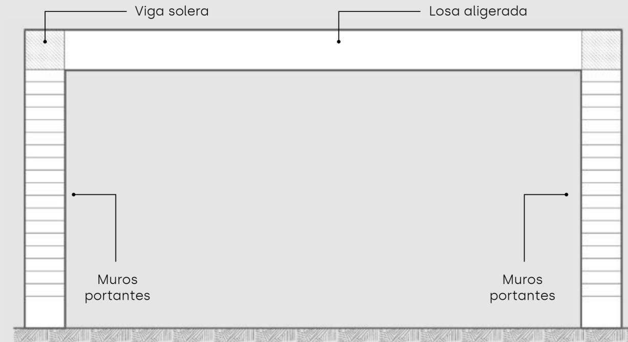
Su altura es igual al espesor de la losa (techo) y su ancho es igual al del muro portante (mínimo 25 cm).
